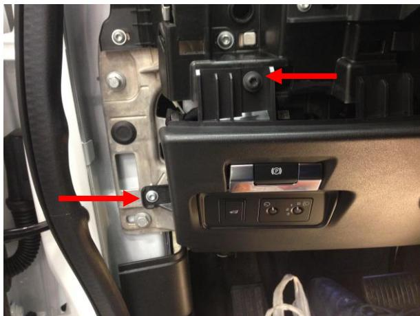
Выкрутить болты. Снять панель, отсоединить фишкы.
