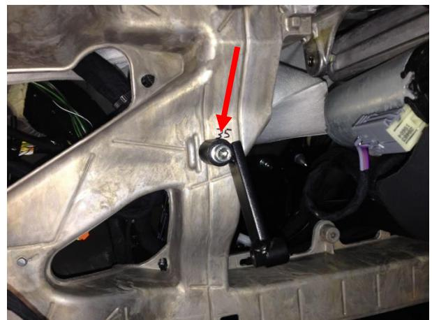
Установить верхнее крепление замка. Болт М6х35 заворачивать с небольшим усилием т.к. болт сам нарезает резьбу в данном отверстии.
