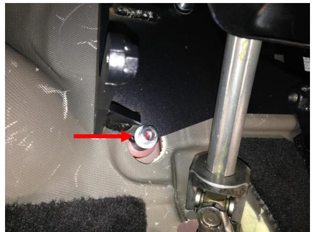
Установить нижнее крепление на свободные шпильки и притянуть срывными гайками с шайбами.
