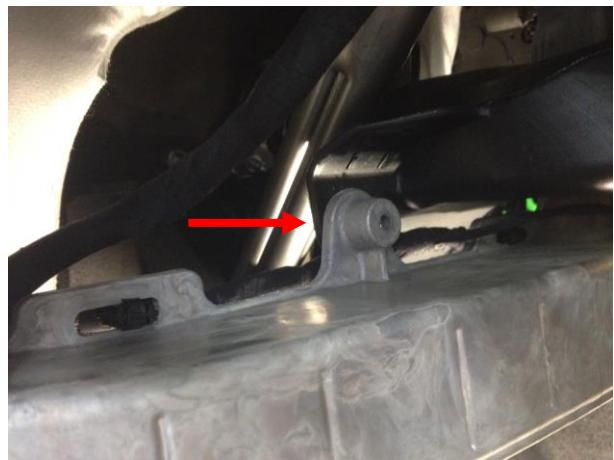
При необходимости выкрутить саморез и снять воздуховод.
