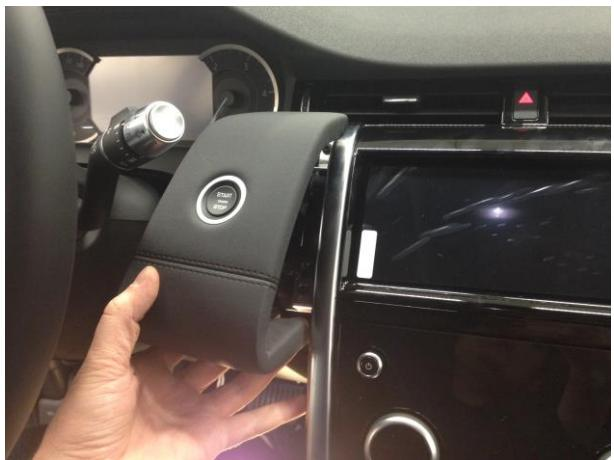
Снять панели, отсоединить фишкы.
